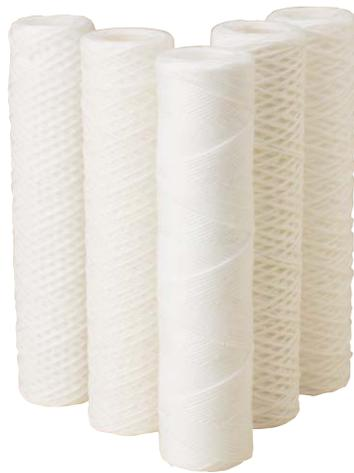
**Los Cartuchos Serie CW Pentair Pentek\* están fabricados desde un cable de polipropileno duradero que se enrolla alrededor de un núcleo de polipropileno rígido. Son una solución económica para reducir el sedimento fino, entre ellos arena, limo, polvo y partículas de escala.**
